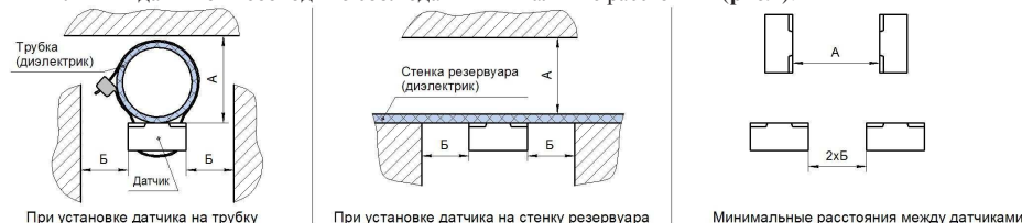
Рис.1 - Минимальные расстояния от датчика до окружающих объектов и между датчиками
