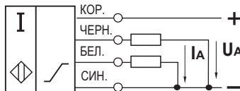
Схема подключения с пропорциональными выходным током и напряжением
