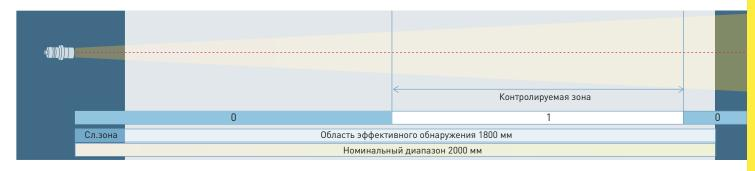
Контролируемая зона находится внутри «окна», ограниченного установленными порогами.
