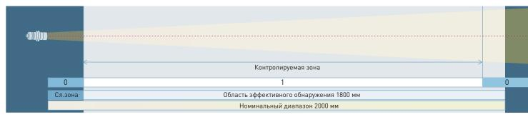
Переключение выходного сигнала происходит при обнаружении объекта внутри контролируемой зоны. Контролируемая зона ограничивается одним порогом.
