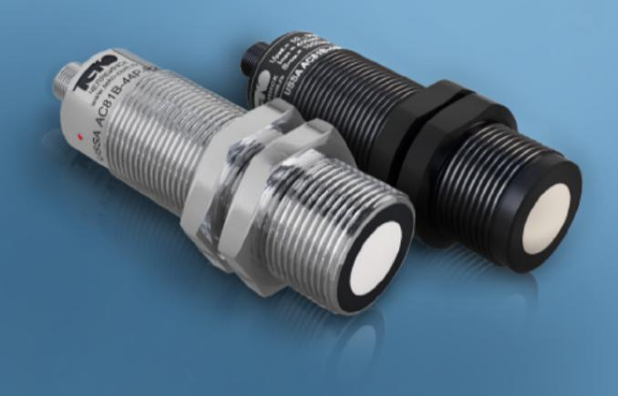
Датчики оборудованы пьезоэлектрическим преобразователем (трансдюсером), излучающим зондирующие ультразвуковые импульсы и принимающим отражённое эхо. Метод вычисления расстояния заключается в преобразовании показателей времени между моментами излучения и приёма отражённого звукового сигнала, учитывая значение скорости распространения звука в воздухе.
