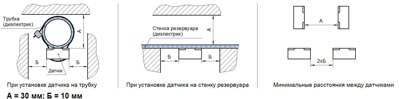
Рис.1 - Минимальные расстояния от датчика до окружающих объектов и между датчиками
